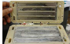
因过度钙化引致电解板剥落.
